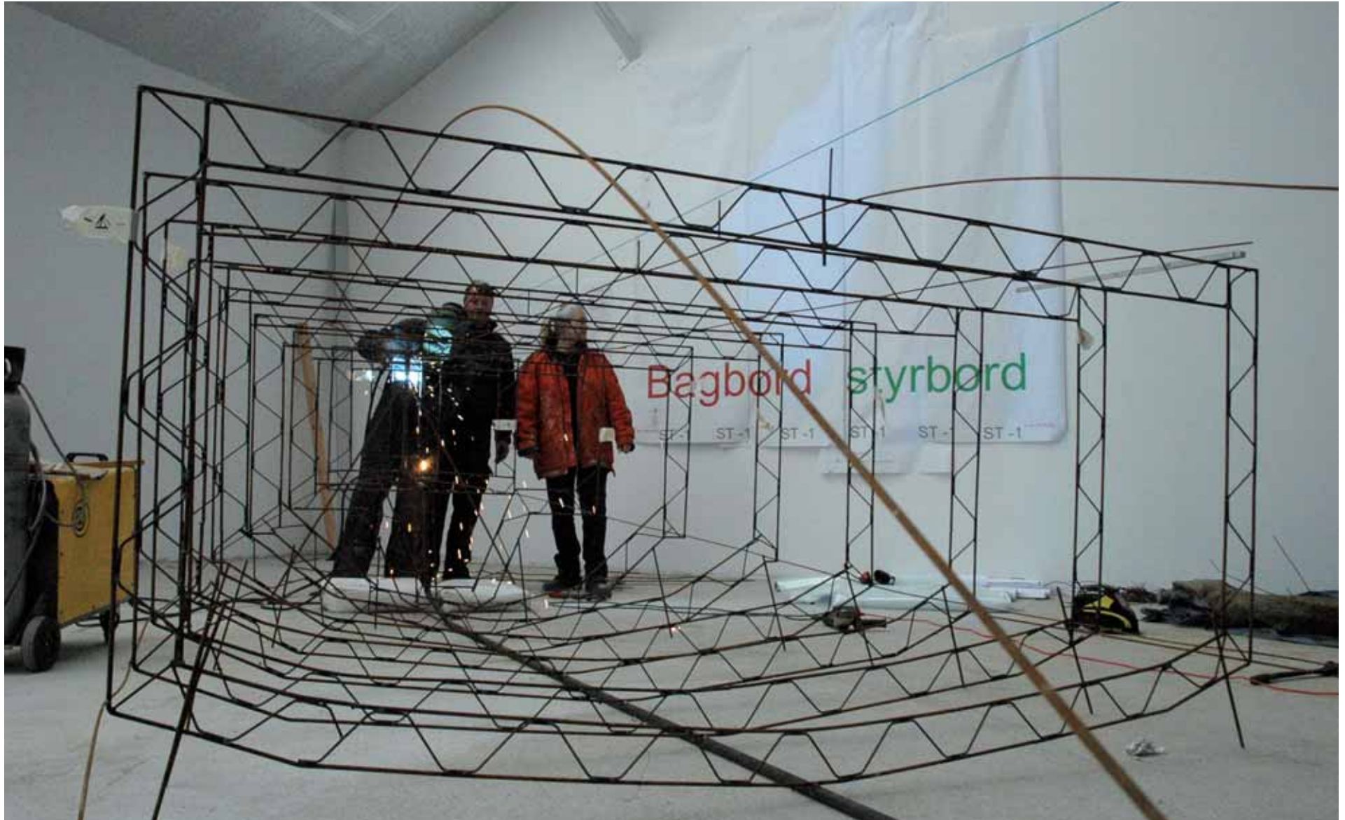
Påbegyndt produktionsproces i 1:1 Spanterne svejses på kølen.
