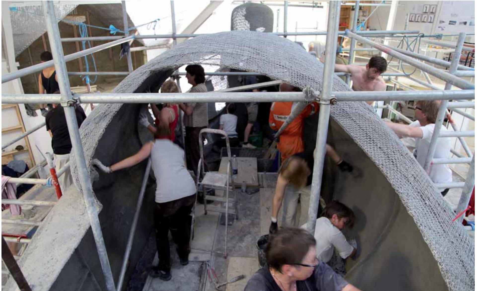
Støbeproses af den første båd, "Mit skib er ladet med Længsel" Pinsen 2012
